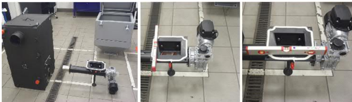
Obr. Kotlové těleso ve vodováze, kontrola podavače
